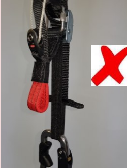
Fig. 13 Trimmerschleife im Hauptkarabiner
