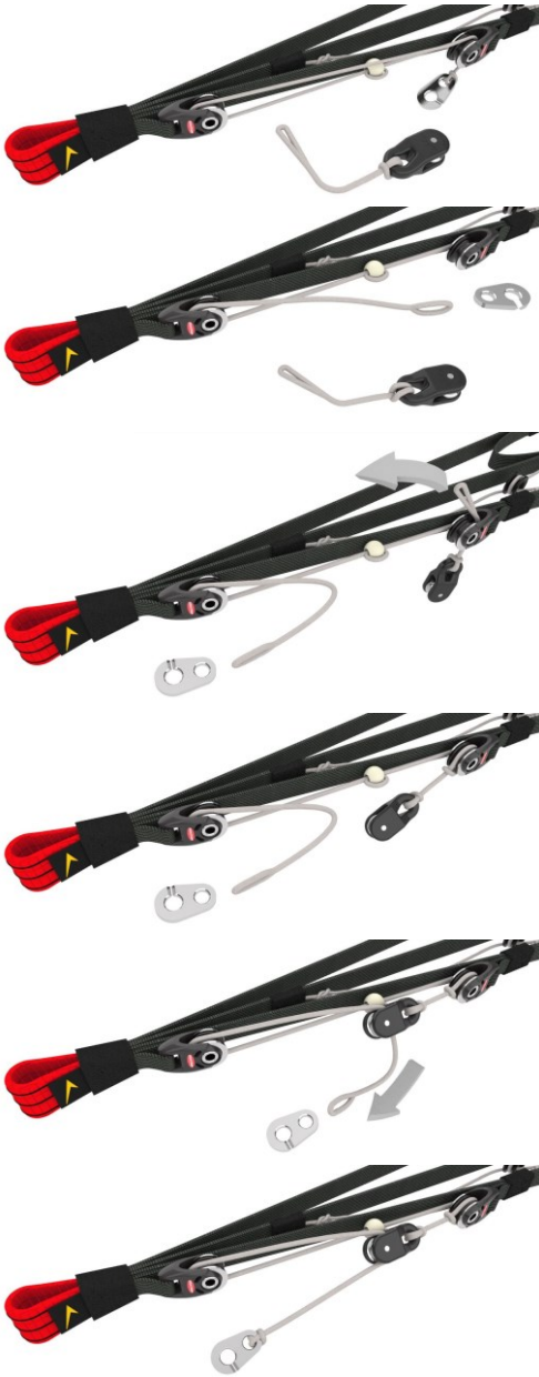
Fig. 8 Bildserie Speedlimiter Einbau
