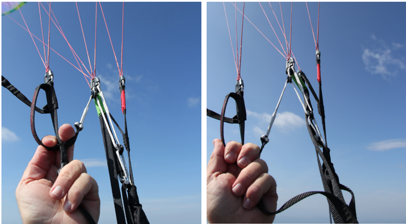
FIG. 1: Um die C-Steuerung zu verwenden, legt man die Finger auf beide C-Tragegurte und fasst den C-Griff. Der aufgebrachte Druck/Zug wirkt im Verhältnis 3: 1 auf die C- und B-Tragegurte.
