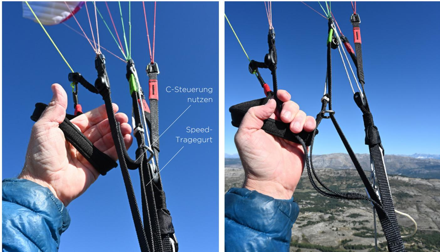
Abb. 1: Behalten Sie die Steuergriffe in den Händen während Sie die C-Steuerung nutzen.
