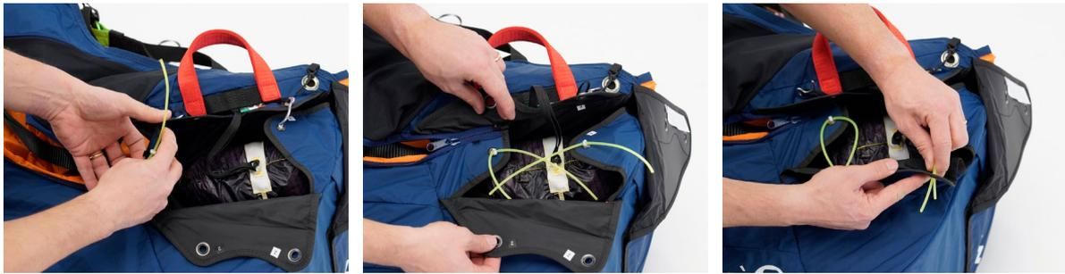
Metallstifte des Griffs in die elastischen Schlaufen und unter die transparente Abdeckung. Die Schnur muss am Ende dieser Phase vollständig entfernt werden. Ziehen Sie sie dazu langsam heraus, um die elastischen Schlaufen nicht durch übermäßige Reibung zwischen den Teilen zu beschädigen. Am Ende muss der Reißverschluss vollständig geschlossen werden, bis der Schieber unter seiner Abdeckung hinter dem linken Schultergurt verschwindet.
