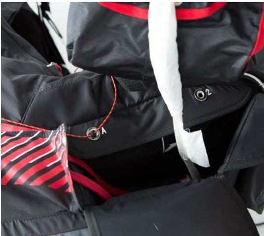
3. V-Leinen in den Verbindungskanal einlegen und mit Klett verschließen
