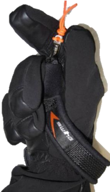
Bild 2 Empfohlene Variante: Hand durch Bremsschleife geführt
