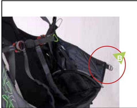
Fädle den Beinstrecker durch die Schließe (B), die sich vorne an der Seitenverkleidung befindet.
