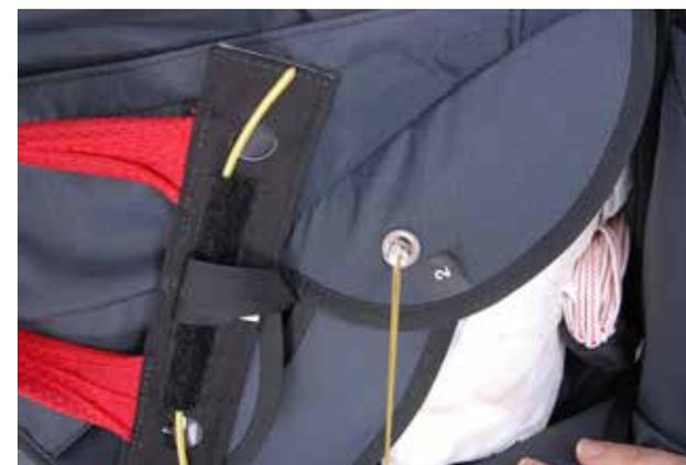
Ziehe die Leine mit den elastischen Loop durch die Öse #3 und stecke den Splint des Griffs durch den elastischen Loop. Dann verstau den Splint mit dem Ende des Griffs hinter die Neoprenlasche #3.
