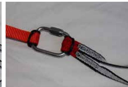
Verschlaufungen der Verbindungsleinen an der Rettungsgeräteaufhängung.
