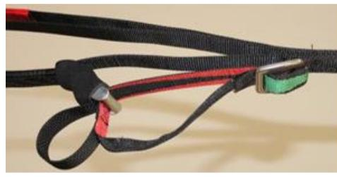
Bild 7 Trimmer geöffnet
