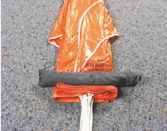
1. Basis S-förmig auf Containerbreite einschlagen (ggf.vorhandene RAM Air Pockets seitlich etwas herausziehen).
