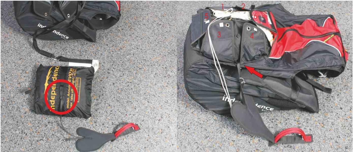
2. Verbindungsleine des Rettungsschirms mit der Verbindungsleine des Gurtzeuges einschlaufen oder mit einem Schraubschäkel (Festigkeit >2400 daN) verbinden. Verbindung (z.B. mit Neoprenschauch) gegen Verrutschen sichern.
