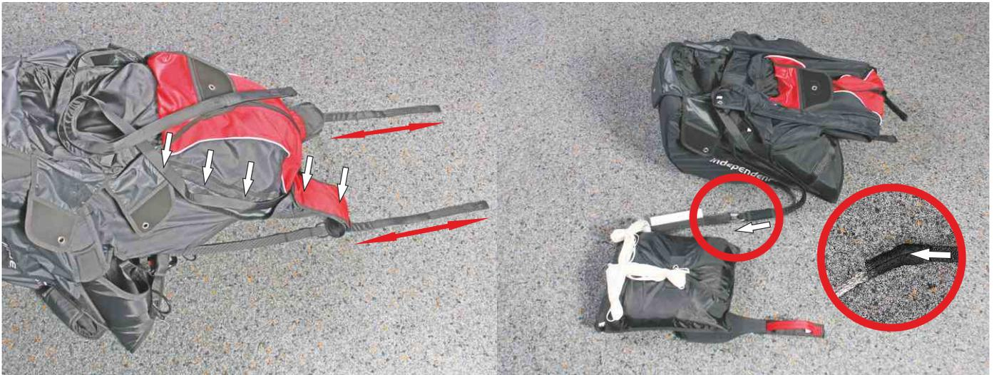
1. Verbindungsleine des Gurtzeuges rechts und links in den vorgesehenen Kanal und die Schultergurte einlegen und in der benötigten Länge (in Abhängigkeit der verwendeten Tandemspreize) herauschauen lassen.
