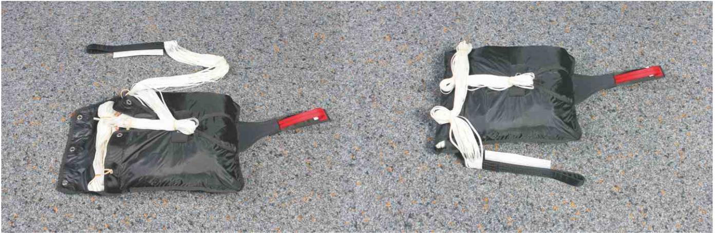
4. Container mit den Fangleinen verschließen. Zuerst wird der rechte Containerflügel mit dem oberen und unteren verschlossen.
