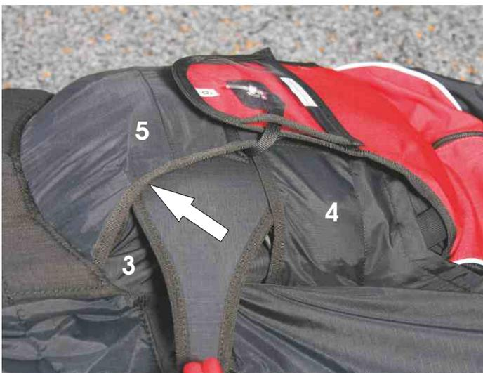
7. Griffabdeckung über Containerlappen 3, unter Containerlappen 4 und 5 stecken.
