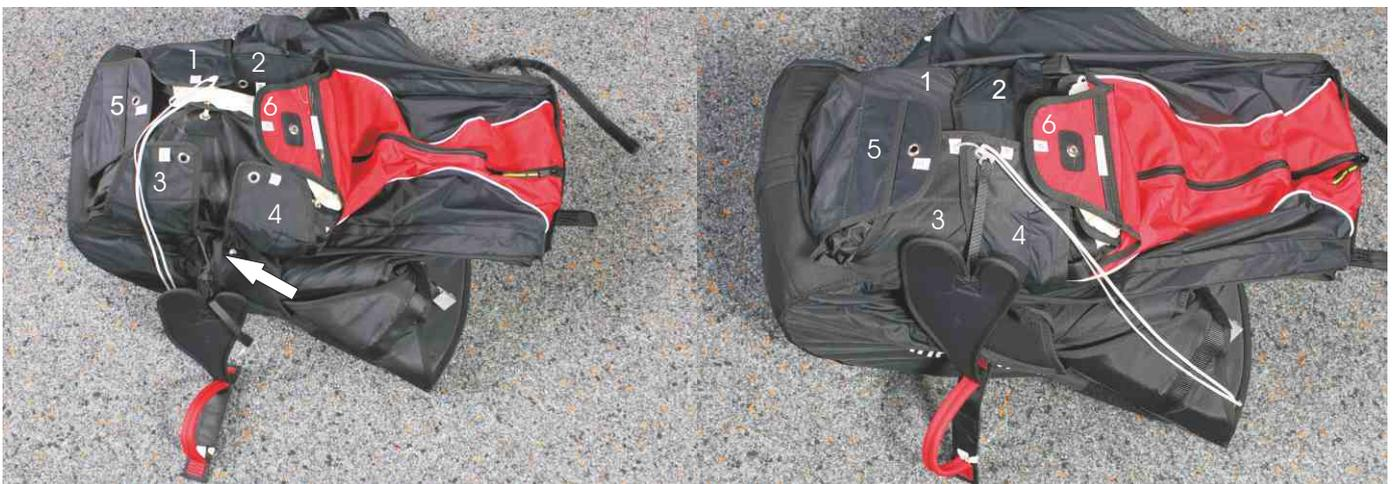
3. Innencontainer einlegen dass die Fangleinen nach außen/oben zeigen. Den Griff zwischen den Containerlappen 3 und 4 herauslaufen lassen. Mit Hilfe einer Packschnur die Containerlappen 1,2,3,4 verschließen.
