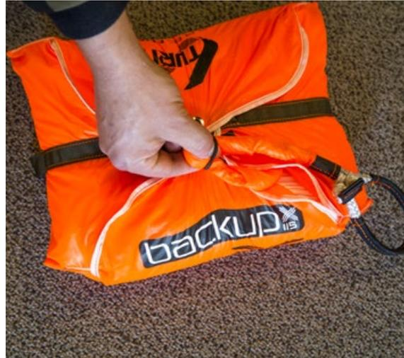
▲ Der Container wird durch durchziehen der Leinenschlaufe durch den Gummi verschlossen
