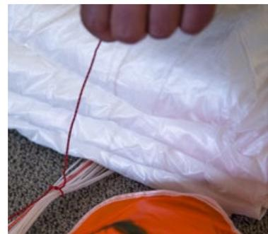
▲ Falls eine Packschnur verwendet wird muss diese nun unbedingt entfernt werden
