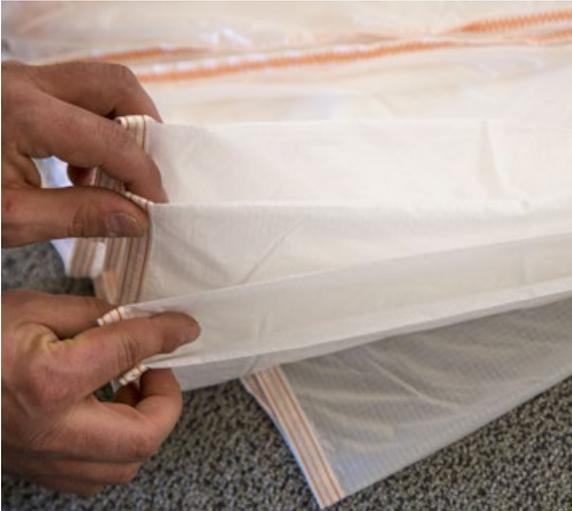
◀ Nun Bahn für Bahn auf die rechte Seite legen Stoff möglichst faltenfrei schichten. Nach vier Bahnen folgt die nächste Eckbahn
