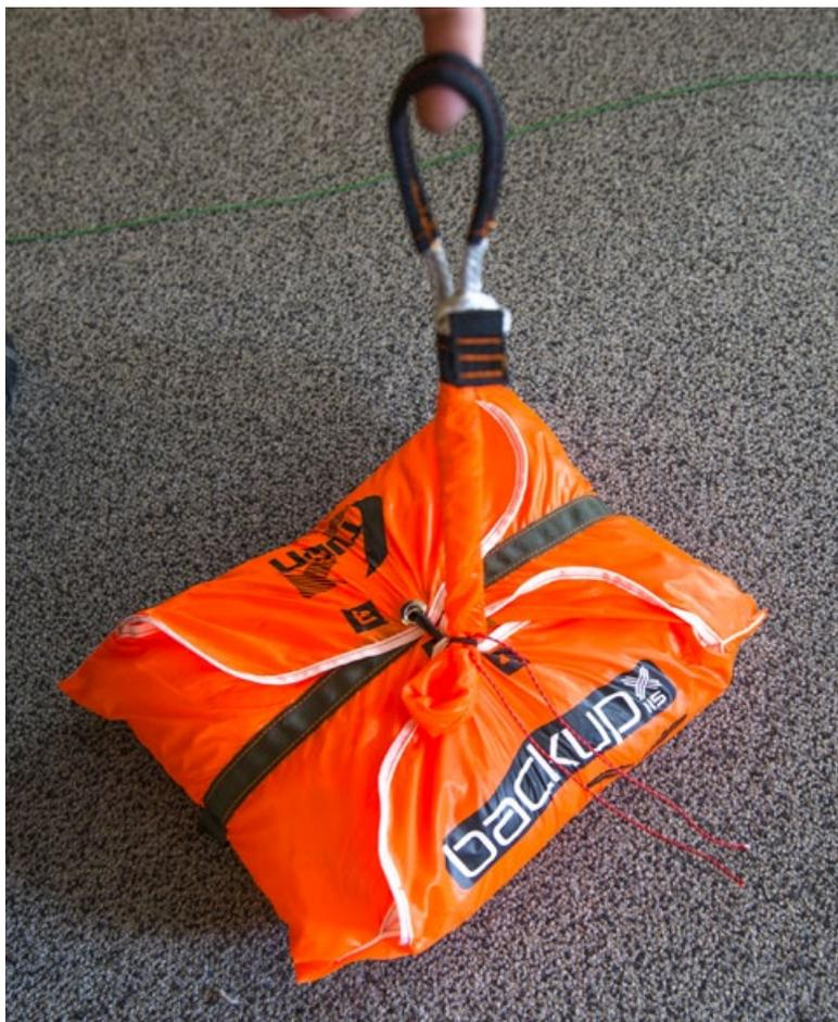
◀ Öffnung durch Eigengewicht prüfen und Packschnur entfernen
