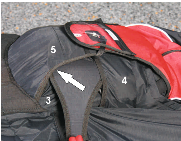
7. Griffabdeckung über Containerlappen 3, unter Containerlappen 5 stecken.
