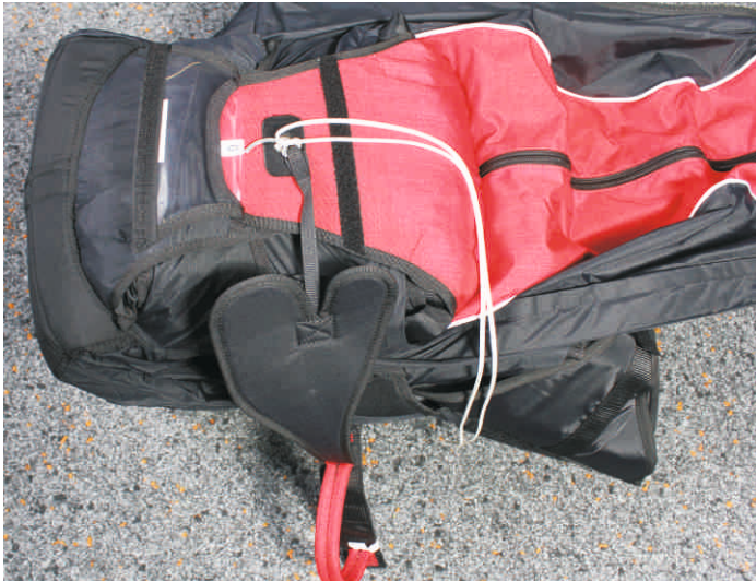
5. Container mit dem Splint verschließen und Packschnur entfernen.
