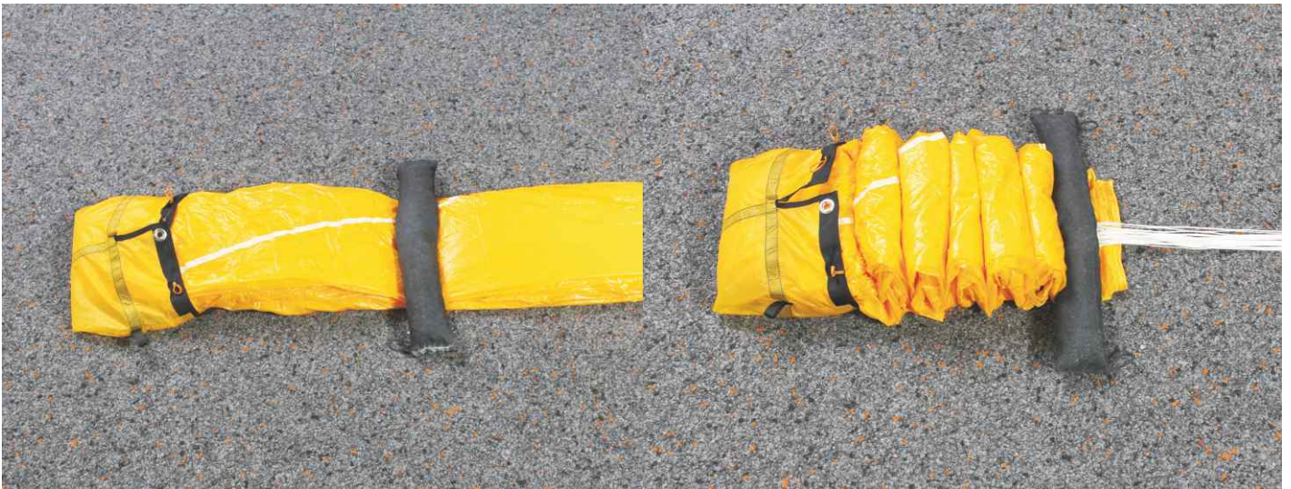
24. Oberes Kappeneinde in den Innencontainer einlegen.
