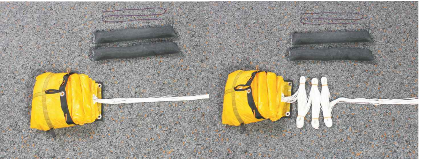
26. S-Schläge in den Innencontainer einlegen.
