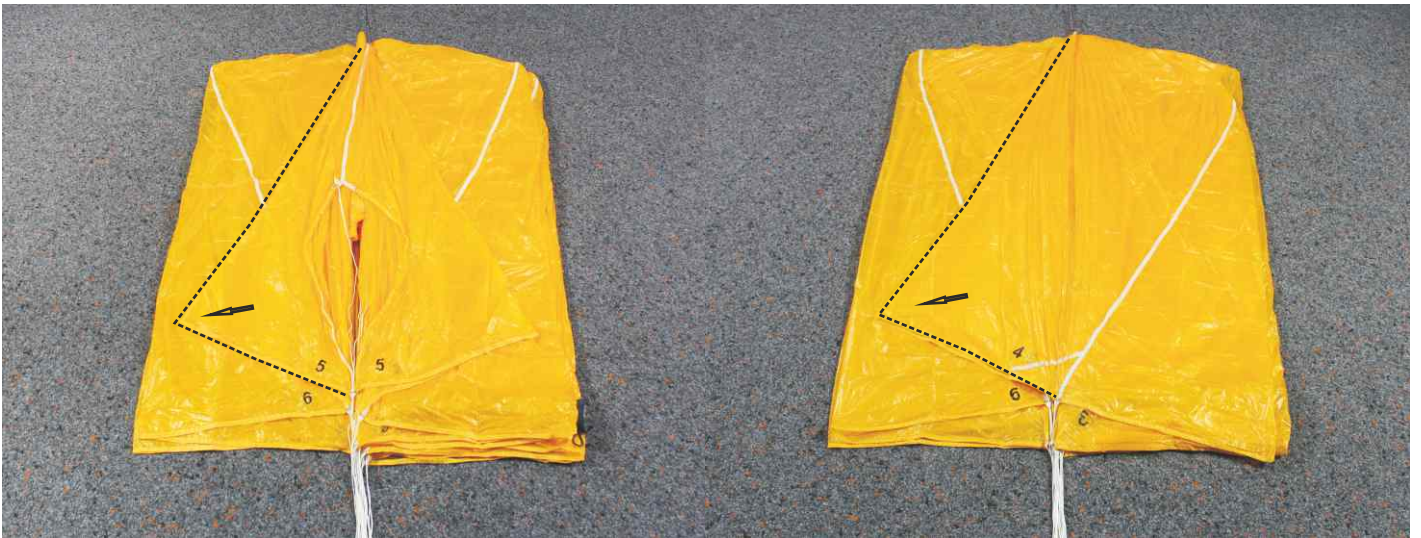
15. Bahn 5 (Ultra Cross 100/125) (Eckbahn) legen. Ultra Cross 150: Bahn 6
