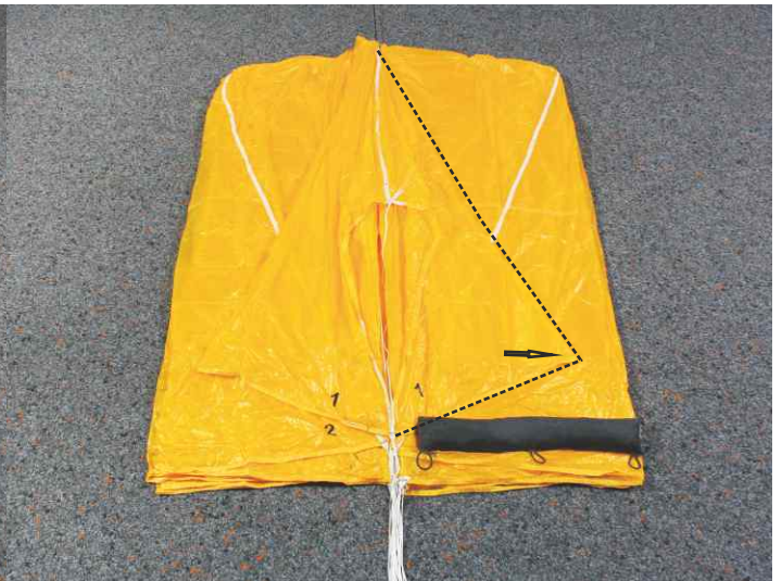
10. Bahn 1 legen (Eckbahn) und Basis mit Gewicht beschweren.
