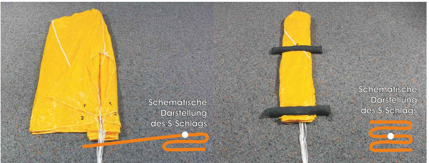
22. Linke Seite S-förmig einschlagen (Schritt 2).
