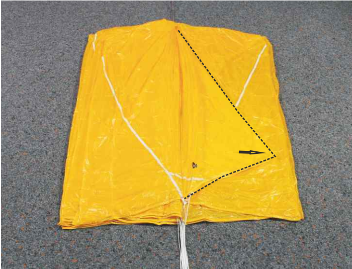
7. Bahn 4 (Ultra Cross 100/125) legen. Ultra Cross 150: Bahn 5
