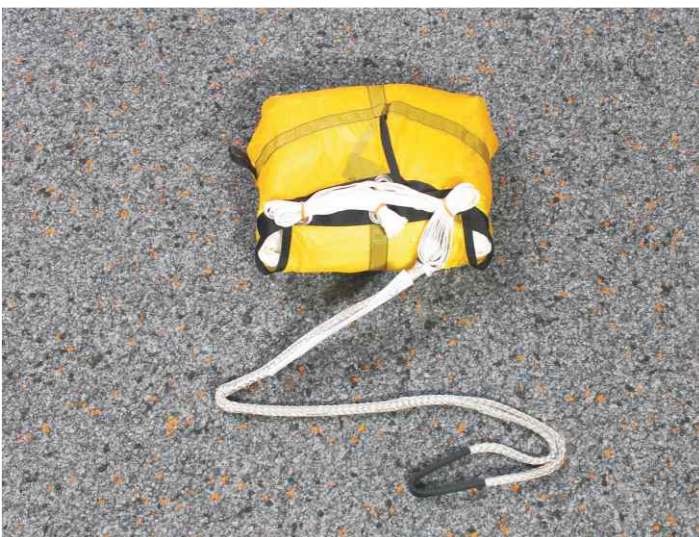
28. Innencontainer mit den Fangleinen verschließen. Zuerst die Mitte, dann Außen.
