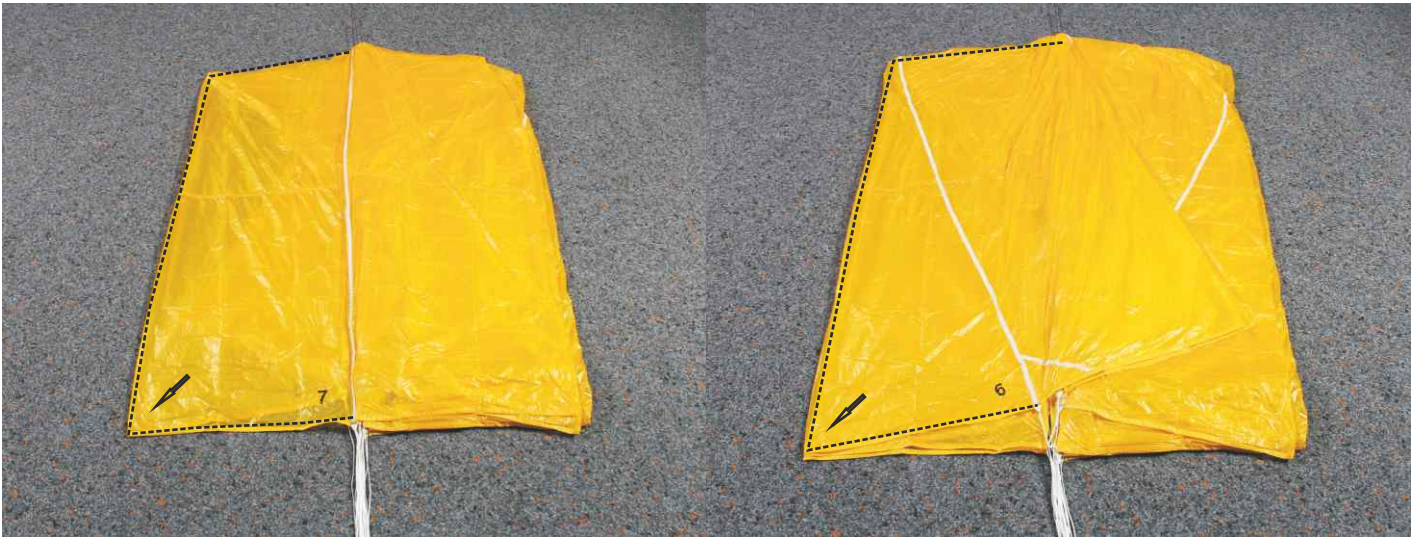
13. Bahn 7 (Ultra Cross 100/125) legen. Ultra Cross 150: Bahn 9
