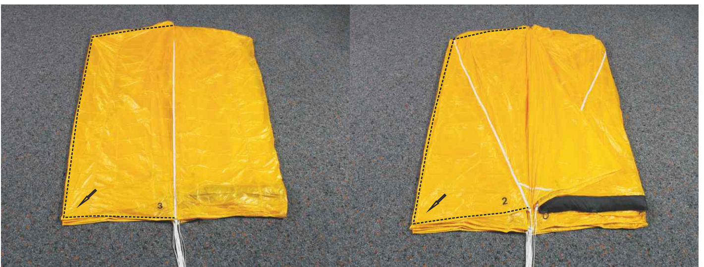
17. Bahn 3 (Ultra Cross 100/125) legen. Ultra Cross 150: Bahnen 4+3
