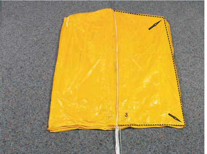
8. Bahn 3 (Ultra Cross 100/125) legen. Ultra Cross 150: Bahnen 4,3
