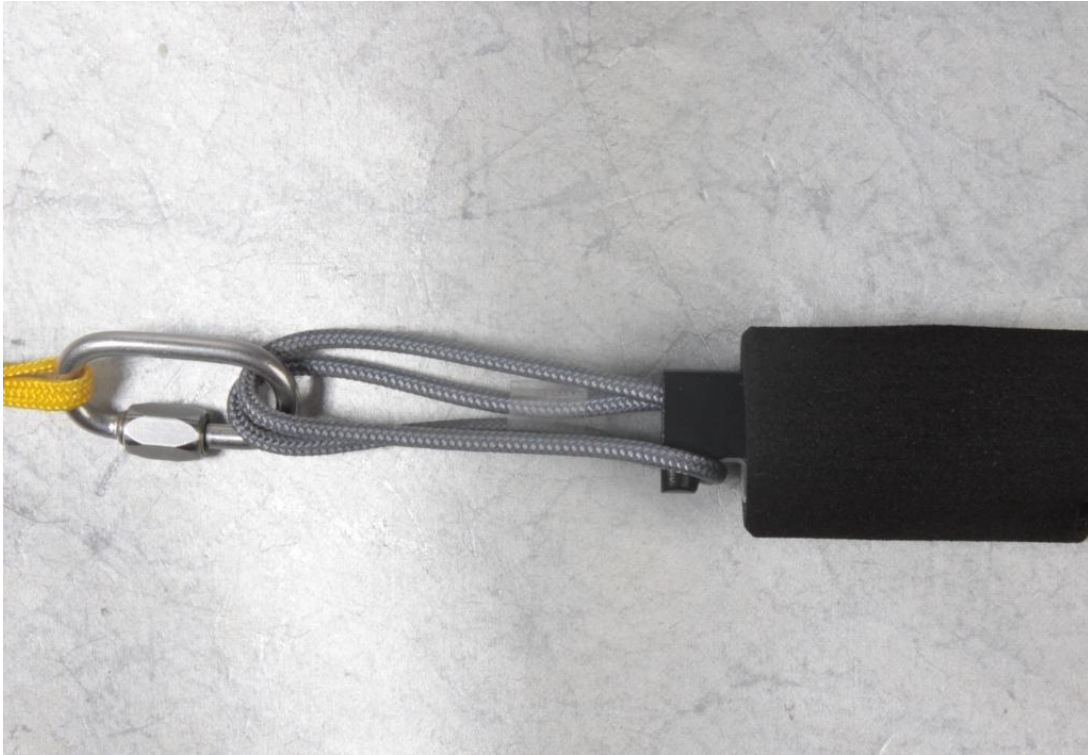
Abbildung 5.2: Einhängen des Befestigungsseils
