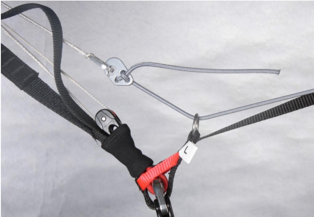
Abbildung 4.3: Einhängen des Vorbeschleunigers
