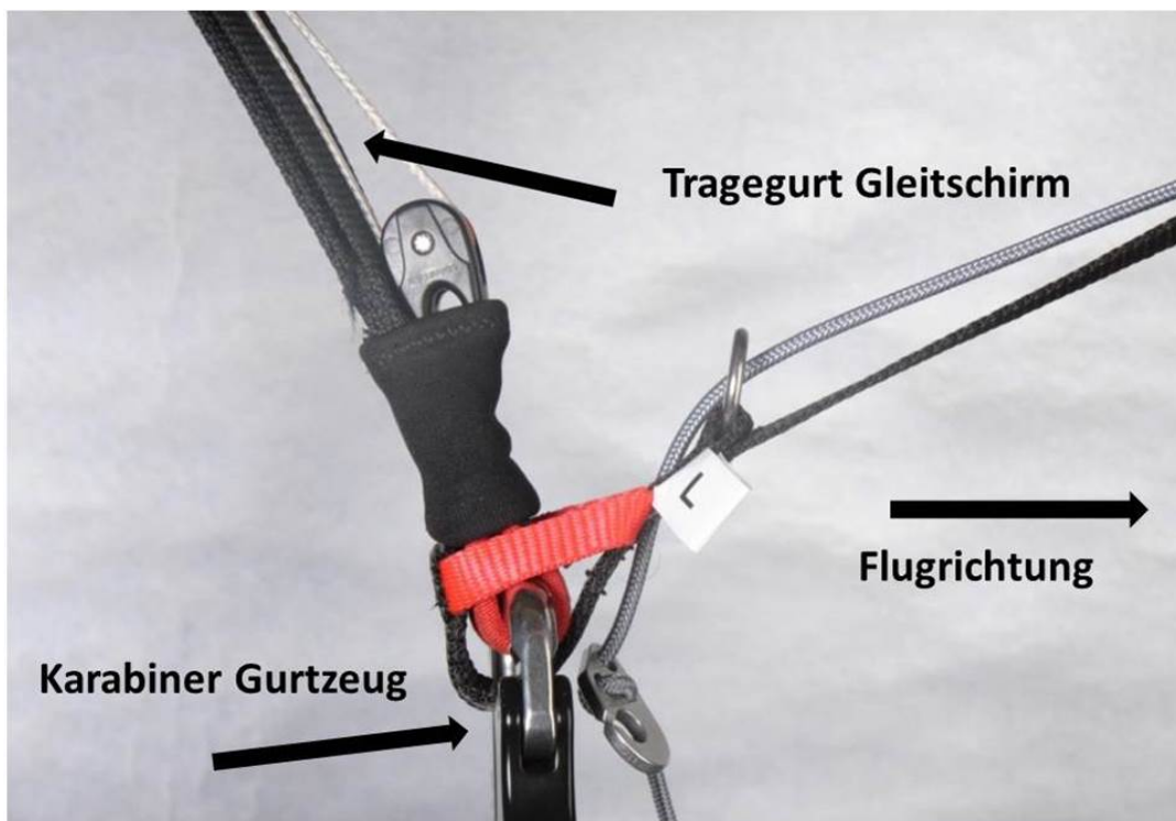
Abbildung 4.1: Detailsicht der Einhängung am linken Karabiner des Gurtzeuges (ohne einhängen Beschleuniger)
